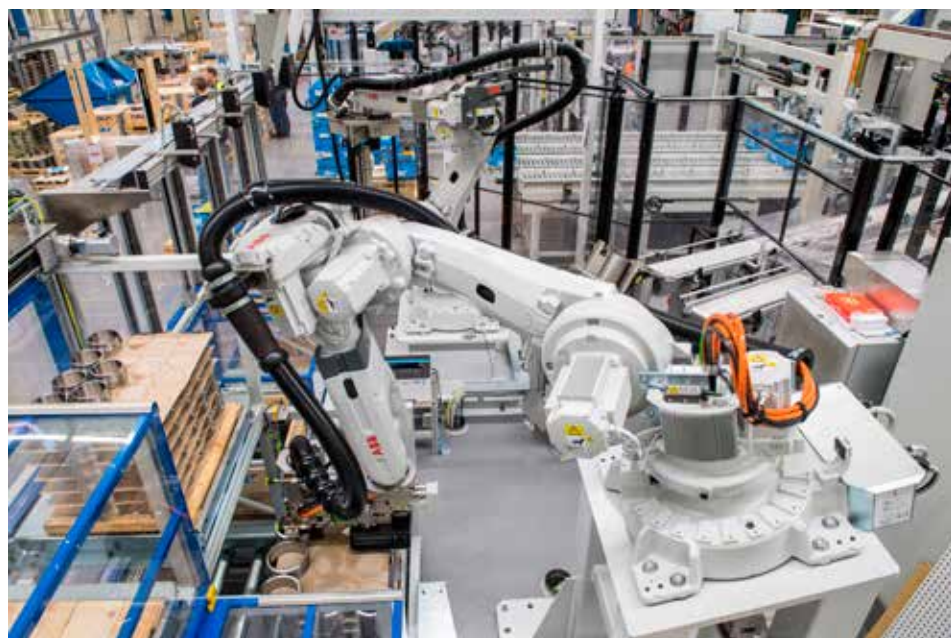
Sedan april i år sköter robotar slutmonteringen av rullager i SKFs fabrik i Göteborg. Det är den första automatiska monteringen av rullager i världen.
