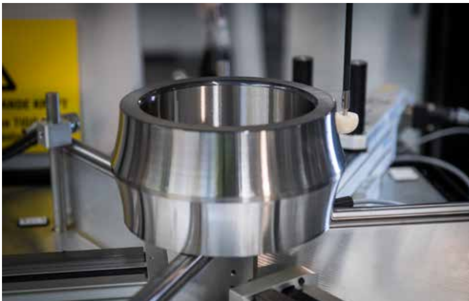
Innerring till rullager på väg i produktionslinan.
